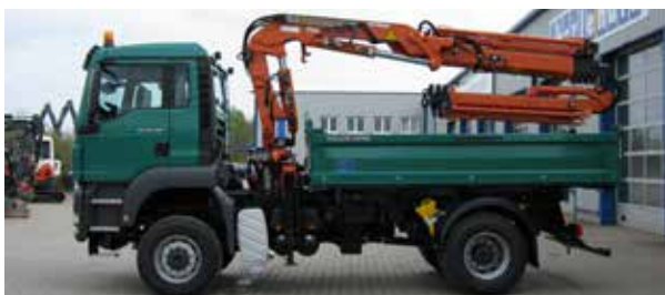
Dreiseitenkipper mit Frontkran ATLAS AK 165.2E und Jib
