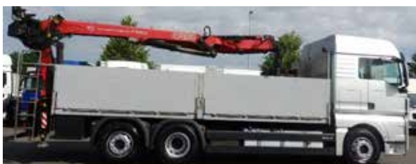
Baustoffpritsche mit Ladekran FASSI F195 AS
