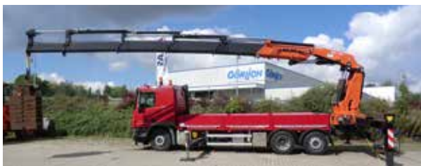
Pritschenaufbau mit Heck-Ladekran ATLAS AK 620.3E
