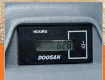
Betriebsstundenzähler (vom Boden aus ablesbar)
