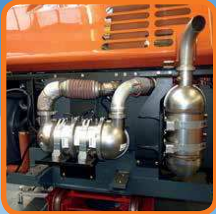
Leise und leistungsfähige Abgasanlage
