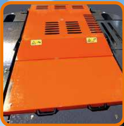
Motorhaubendesign für bessere Sichtverhältnisse
