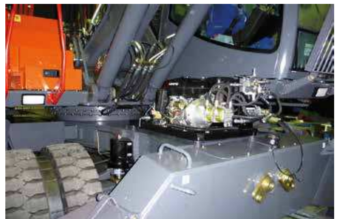
BENZIN-BETRIEBENES NOTAG- GREGAT ZUR BEWEGUNG DER MASCHINE
