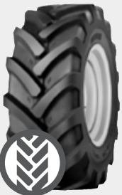
Traktionsprofil - Michelin Radialreifen
