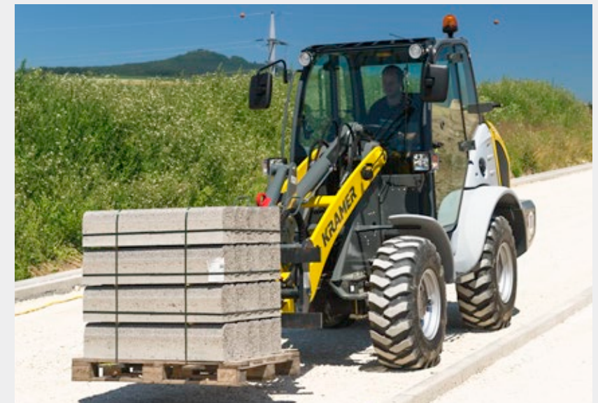
Vorderachslenkung für erhöhte Sicherheit bei schnellen Transportfahrten
