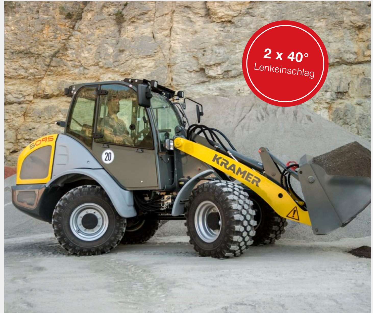
Allradlenkung besonders wendig bei eingeschränkten Platzverhältnissen
