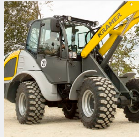
Hundeganglenkung für präzise Positionierung
