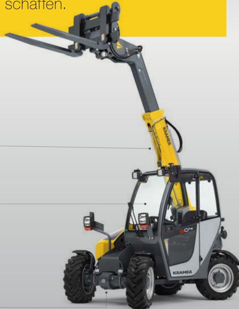
**Für alle Arbeiten optimiert:** Ein Kramer bietet Übersicht und gibt Sicherheit. Eine perfekt abgestimmte Kabine, weit heruntergezogene Scheiben und ein gefederter Komfortsitz sind die Basis für effektive Arbeitsleistung. Abgerundet wird dies durch den Joystick, der zahlreiche Hebel ersetzt.
