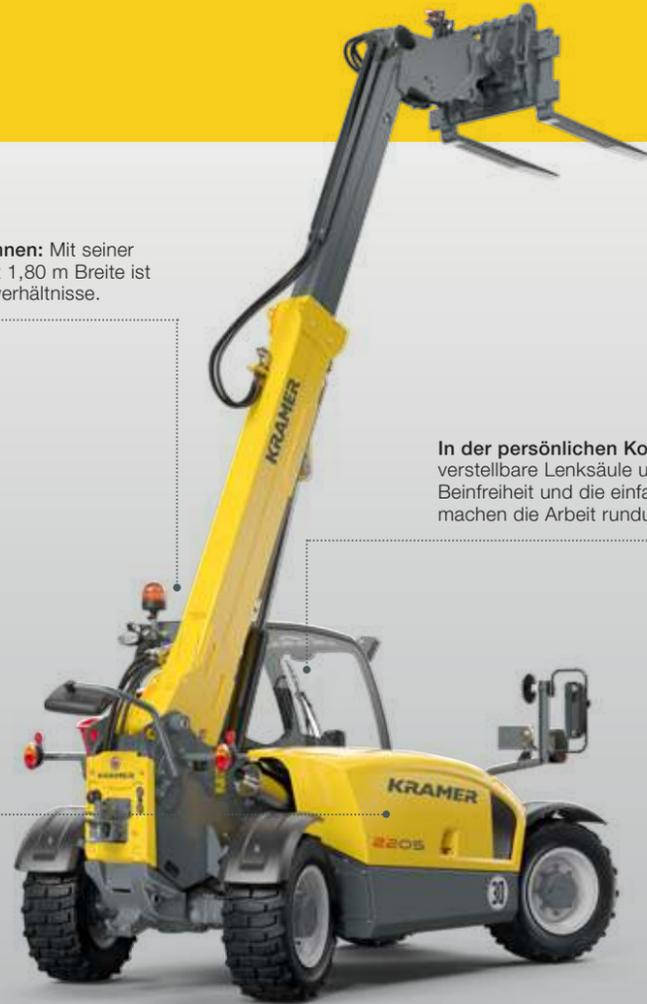
**2,7 Tonnen Nutzlast fast 6 Meter hoch heben.**
