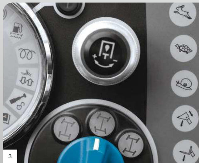
3 Immer optimale Ergebnisse: Über das Drehpotentiometer lässt sich für alle Steuerkreise die Ölmenge stufenlos einstellen.
