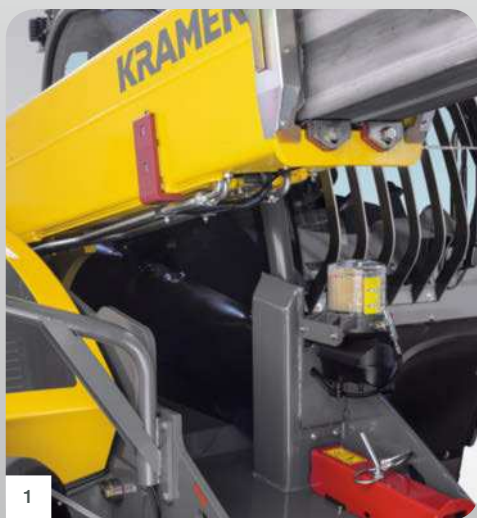
1 Zuverlässig gestützt: Der Ausleger wird bei Materialaufnahme seitlich gestützt und die Krafteinwirkung in den Rahmen geleitet.
