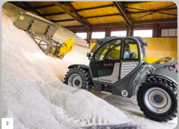
2 Schutz vor Werteverlust: Der zusätzliche Korrosionsschutz wurde speziell auf den Einsatz mit aggressiven Medien wie Salz oder Düngemittel ausgelegt.
