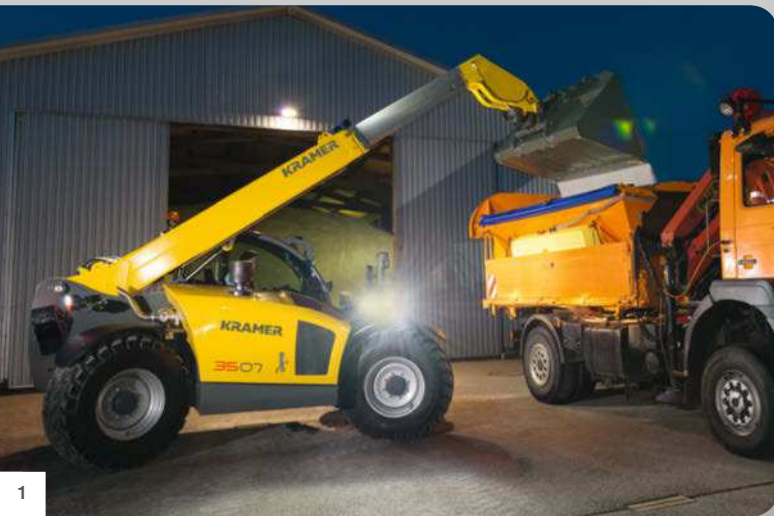
1 Dunkle Wintertage erhellen: Auf Wunsch wird die Maschine mit bis zu acht LED-Arbeitscheinwerfern mit einer Leistung von je 2.200 Lumen ausgestattet.
