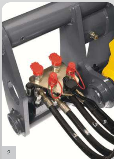
2 Gut geschützt: Die Anschlüsse für den 3. Steuerkreis sind in der Schnellwechsellplatte integriert.
