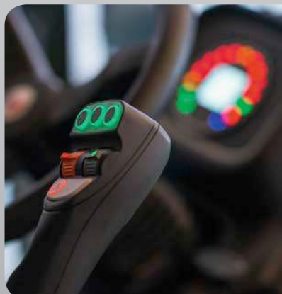
Feinfühliges und präzises Steuern von Maschine und Anbaugerät per hydraulisch vorgesteuertem Joystick.
