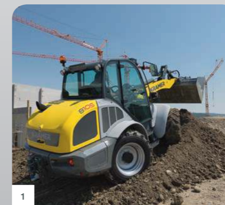
1 Standsicherheit selbst in unwegsamem Gelände: Der ungeteilte Rahmen schafft hohe Stabilität
