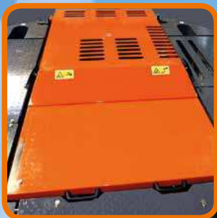
Motorhaubendesign für bessere Sichtverhältnisse
