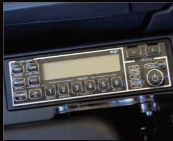
DAB+-Radio (FM/AM & AUX & USB & Bluetooth® & Telefon-Freisprecheinrichtung)
