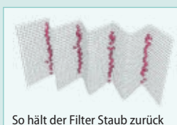
So hält der Filter Staub zurück
