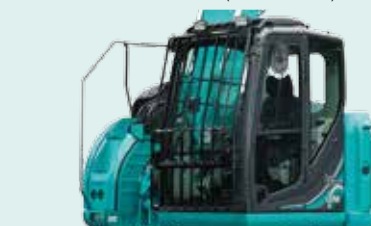
Dach-Schutzgitter Stufe II (erfüllt ISO10262)
