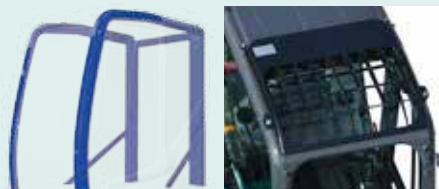
Dach-Schutzgitter Stufe II (erfüllt ISO10262)
