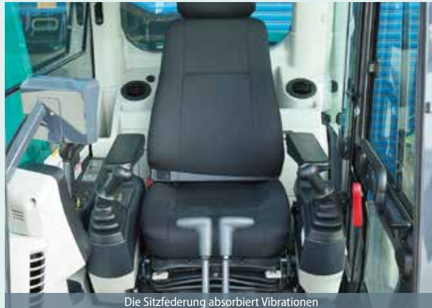
Die Sitzfederung absorbiert Vibrationen
