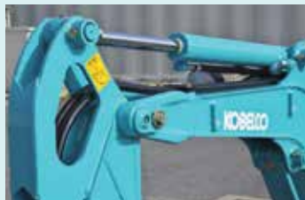
Löffelzylinderschläuche befinden sich im Stiel
