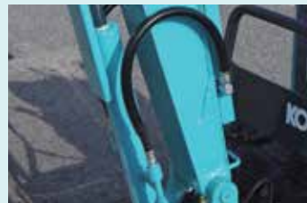
Auslegerzylinder-Schläuche aus zwei Teilen
