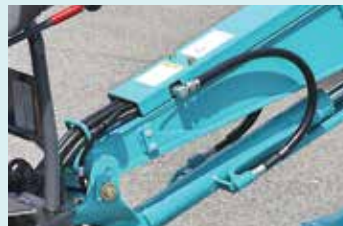
Schutzabdeckungen für die Schläuche hinter dem Ausleger
