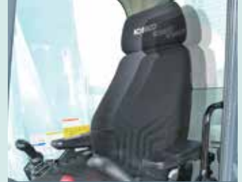
Doppel-Führungsschienen ermöglichen die Einstellung für optimalen Komfort
