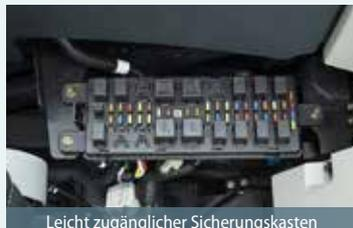
Leicht zugänglicher Sicherungskasten
