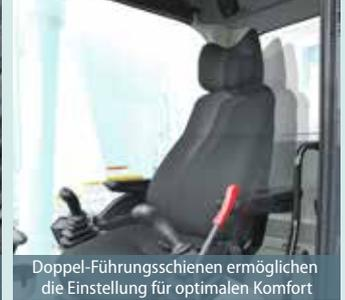
Doppel-Führungsschienen ermöglichen die Einstellung für optimalen Komfort
