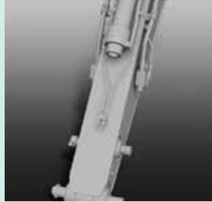
Separate Hydraulikleitung für einen Schnellwechsler, mit dem Anbaugeräte schnell gewechselt werden können.
