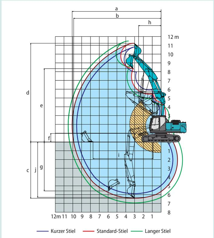
Der mit diagonalen Linien markierte Bereich zeigt den Warnbereich der Fahrerhaus-Schutzeinrichtung.
