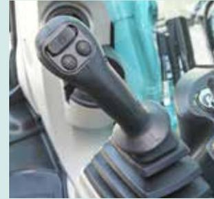
Man benötigt 25 % weniger Anstrengung, um den Bedienhebel zu betätigen, wodurch Ermüdungserscheinungen bei langem Arbeiten oder andauerndem Betrieb verringert werden.
