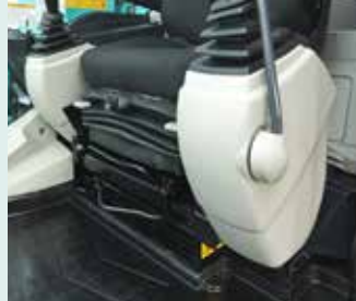
Die Sitzfederung absorbiert Vibrationen
