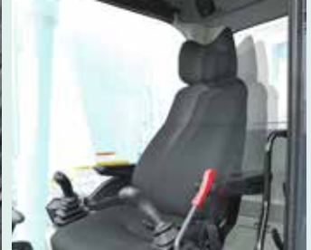
Doppel-Führungsschienen ermöglichen die Einstellung für optimalen Komfort
