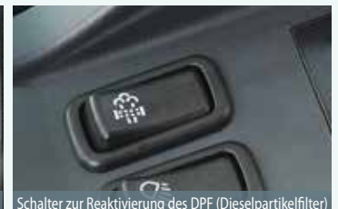
Schalter zur Reaktivierung des DPF (Dieselpartikelfilter)
