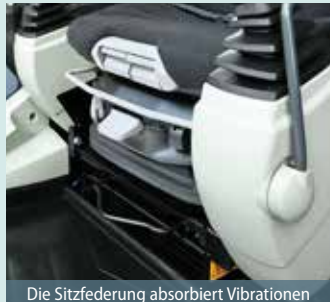
Die Sitzfederung absorbiert Vibrationen
