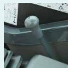
Der Planierschild-Hebel verfügt für einen präzisen Betrieb über eine Hydraulik-Vorsteuerung.
