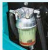
Kraftstoffvorfilter mit eingebautem Wasserabscheider
