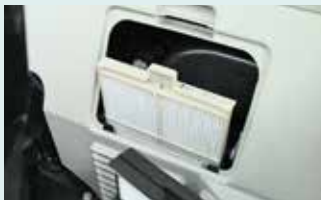
Klimaanlagenfilter können einfach und ohne Werkzeug zur Reinigung entnommen werden. Einer für Außenluft und einer für Innenluft.
