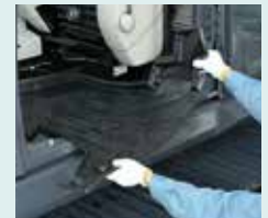
Herausnehmbare, zweiteilige Bodenmatte mit Griffen zur einfachen Entnahme.
