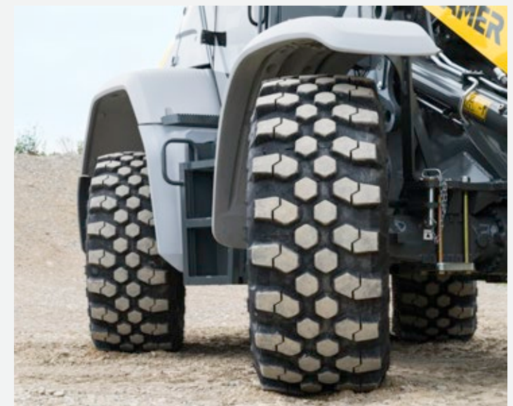
Hundeganglenkung für maximale Flexibilität
