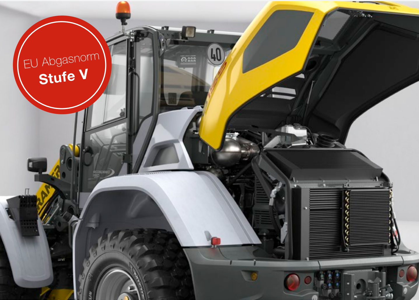
Wassergekühlter 4-Zylinder Reihomotor mit gekühlter externer Abgasrückführung, Turboaufladung sowie Ladeluftkühlung.
