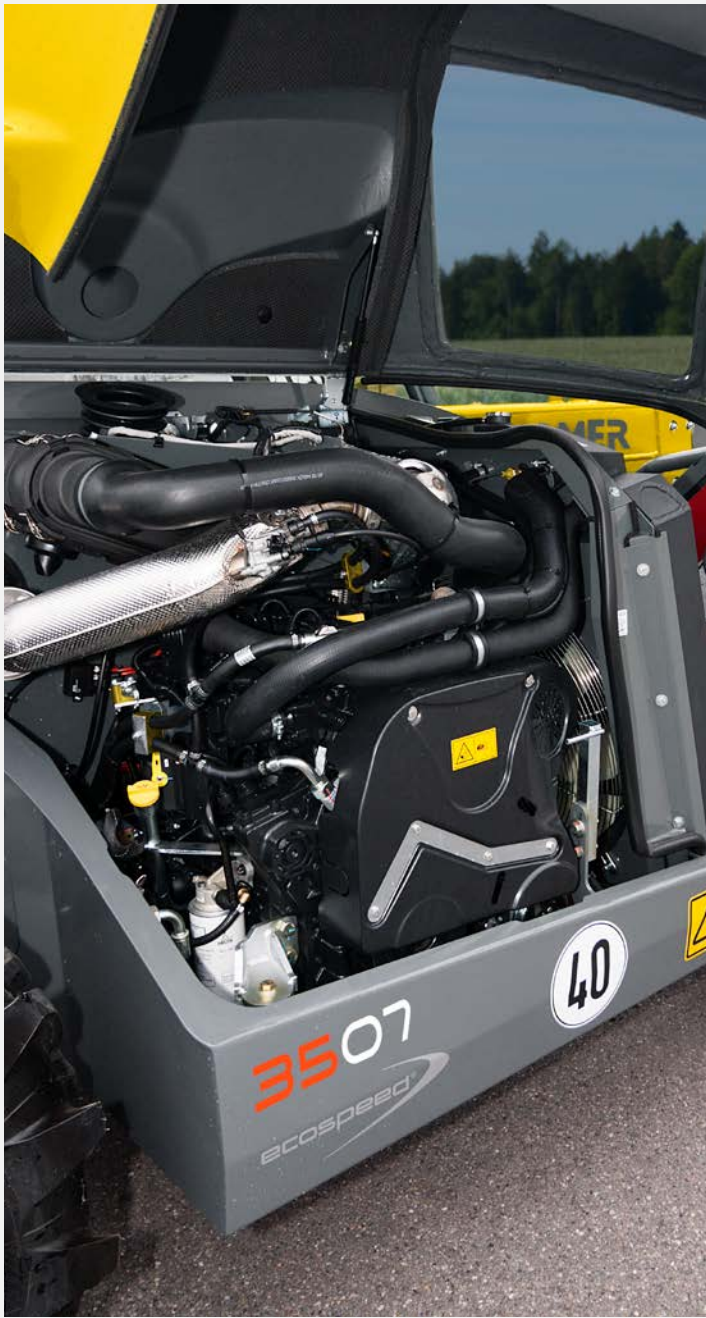
Wassergekühlter 4-Zylinder Reihenmotor mit gekühlter externer Abgasrückführung, Turboaufladung sowie Ladeluftkühlung.
