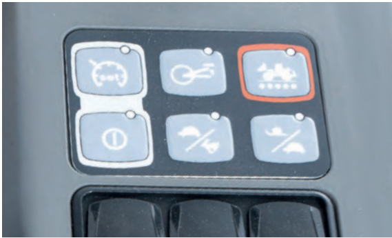
Controller: Variable Tastenfelder für Fahren und Arbeiten
