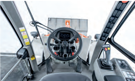
Vorne: Bodentief freie Sicht ohne störende Lenksäule
