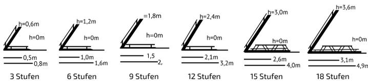
**Gitterfachwerk** In der Grundversion der Treppe liegt der Verstellbereich von 0° bis 50° nur für die Module mit 3, 6, 9 und 12 Stufen. Damit man die Bautreppe mit 15 und 18 Stufen auch als Überweg nutzen kann, ist der Einsatz von speziellen Traversen vorgesehen (Gitterfachwerk). Auch das Verbinden von den längsten Treppen (15 und 18 Stufen) zum flachen Übergang wird so möglich.
