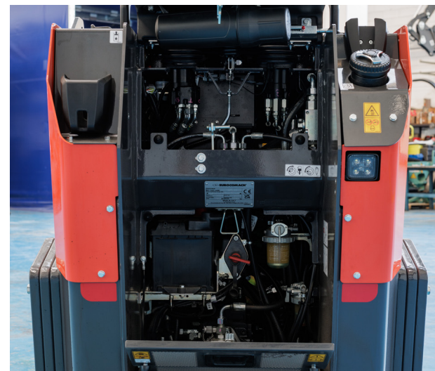
Hinterer Zugang zu Batterie und Pumpe.
