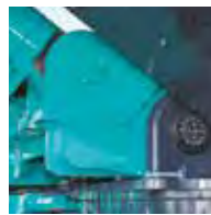
Die Führung zum Ein- und Ausbau des Hilfsrahmens vereinfacht die Ausrichtung
