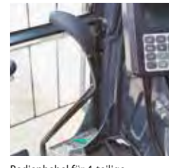
Bedienhebel für 4-teilige Ausrüstung mit hoher Reichweite im Fußbereich
